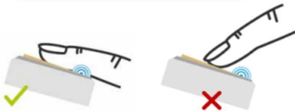
Votre appareil est équipé d'un capteur d'activation permettant à la batterie d'avoir une longue durée de vie, d'environ 6 mois. Le capteur d'activation est représenté ici par un symbole bleu. Lors de l'utilisation de l'ekey uno, assurez-vous toujours de toucher le capteur d'activation. Sinon, l'appareil reste inactif.
