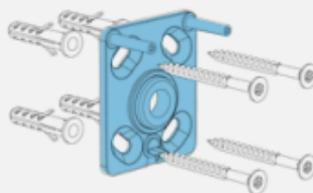
\*HINWEIS: Entfernen Sie die Trägerfolie vollständig. Reinigen Sie die zu beklebende Oberfläche gründlich. Kleben Sie die Montageplatte nur auf glatte, trockene Oberflächen, bei Raumtemperatur. Drücken Sie die Montageplatte **mit viel Druck** auf die zu beklebende Oberfläche. Die maximale Klebekraft wird erst nach 3 Tagen erreicht. Erst dann ist die Montageplatte voll belastbar.
